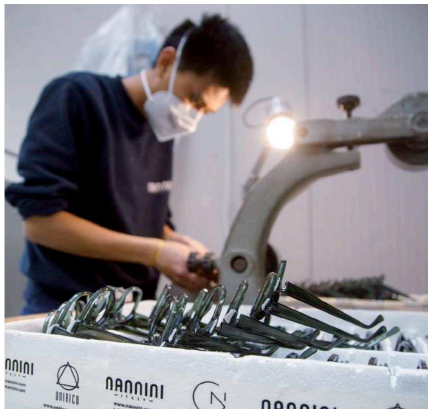
Alcune delle fasi di realizzazione del prodotto: burattatura, pianatura e lucidatura
