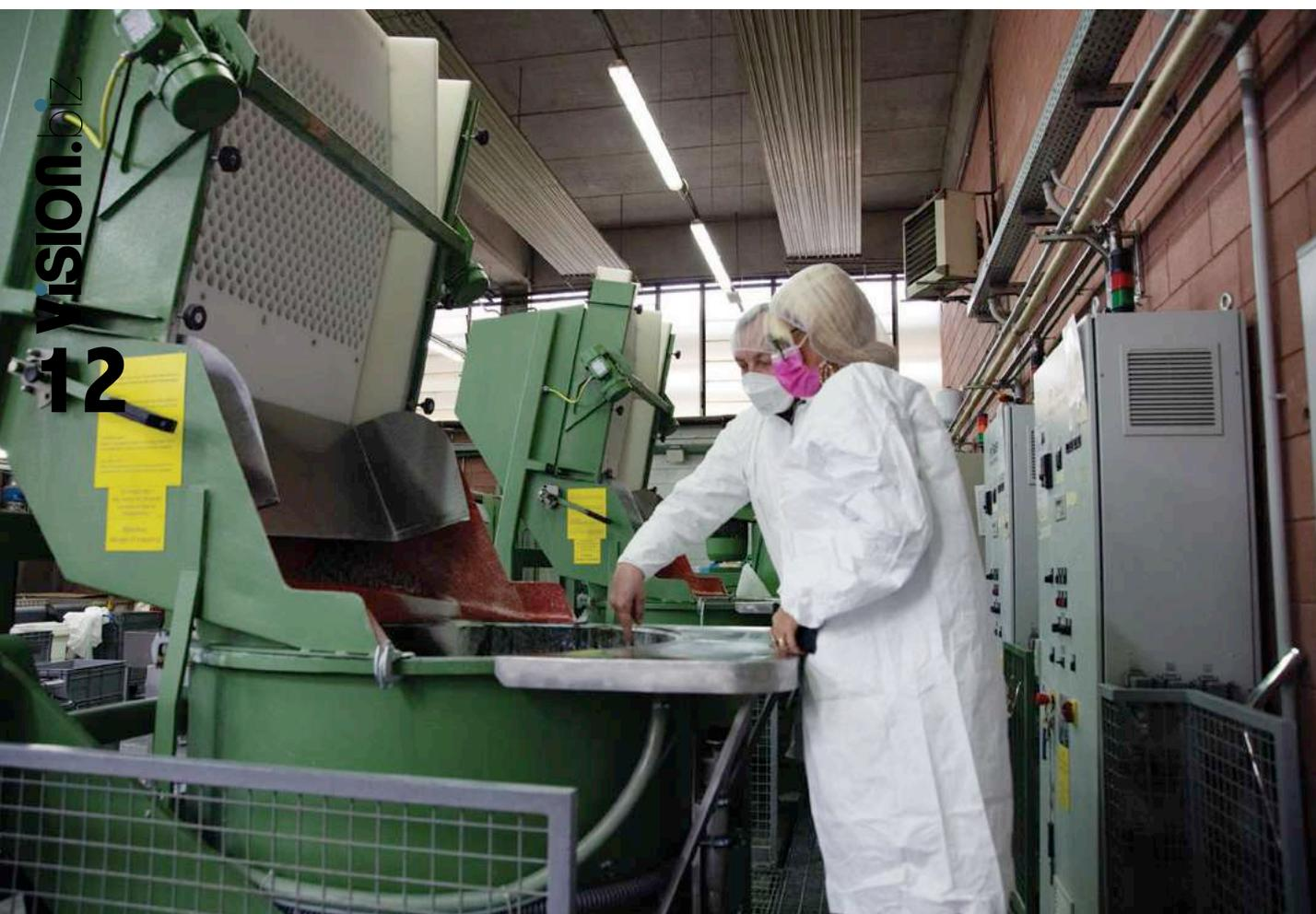
Nel reparto burattatura vengono utilizzate macchine centrifughe o a vibrazione gestite da un particolare impianto che, nell'ottica di ecostenibilità sposata da Mirage, permette di ridurre drasticamente i costi del consumo dell'acqua e il relativo smaltimento
