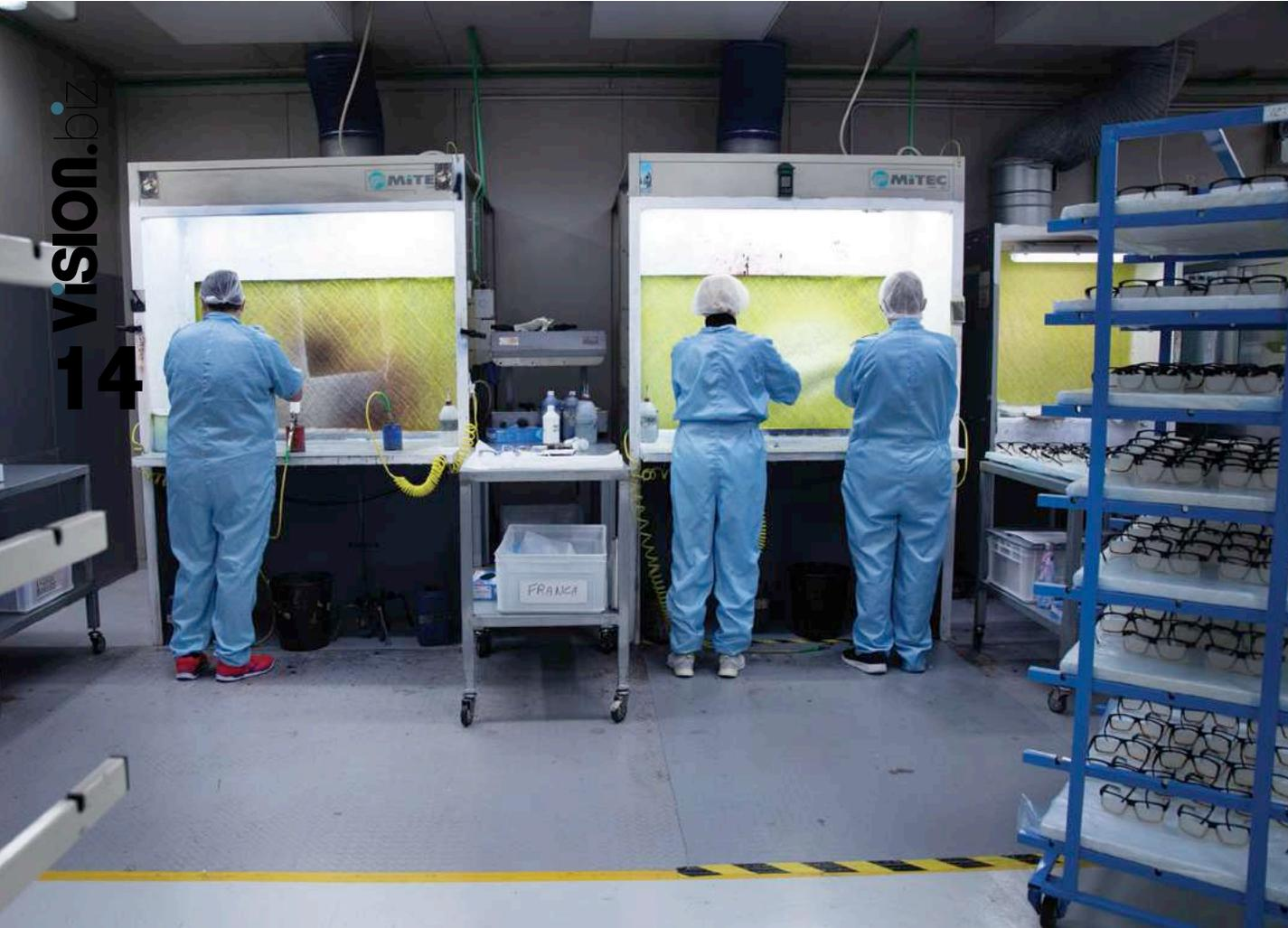
Il reparto verniciatura è collocato in una struttura esterna ai due capannoni principali dell'azienda. Qui, sia agli operatori che ai visitatori viene chiesto di indossare appositi indumenti protettivi per non inquinare la lavorazione del prodotto
