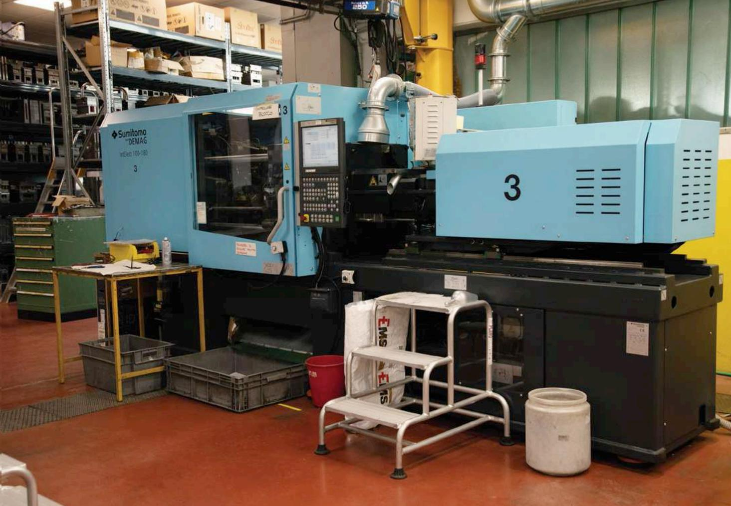
La maggior parte delle presse a iniezione oleodinamiche sono state sostituite con macchine dai motori elettrici a corrente continua. Nella foto in basso a sinistra, una delle stampanti 3D utilizzate in fase di progettazione
