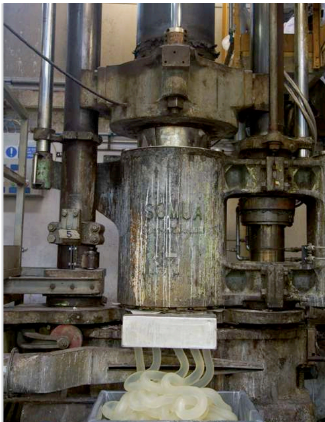
I processi di lavorazione partono dal passaggio della materia prima in un apposito filtro che ne elimina le eventuali impurità. Si procede poi con la miscela delle polveri per ottenere il colore desiderato
