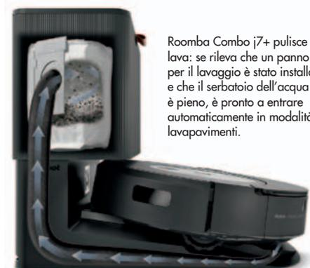
Roomba Combo i7+ pulisce e lava: se rileva che un panno per il lavaggio è stato installato e che il serbatoio dell'acqua è pieno, è pronto a entrare automaticamente in modalità lavapavimenti.
